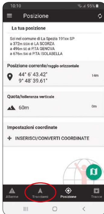
Appena avviata, l'applicazione prende il punto e ci dà le coordinate della nostra posizione. Selezionando l'opzione "Tracciami", come mostrato in figura, si passa nel menu che ci permette di fare il rilievo.
