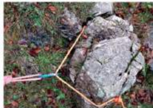
Anello di cordino su sasso (ancoraggio intermedio) chiuso e regolato con nodo delle guide doppio.
